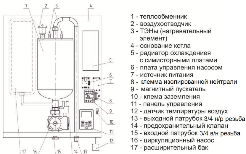
Рисунок 2. Устройство отопителя РЭКО серии ПМ
