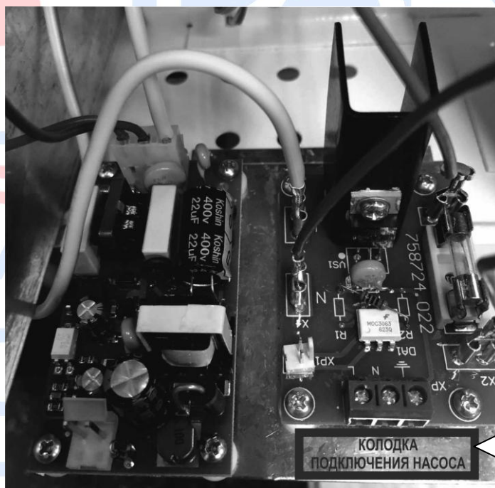
Рисунок 5. Подключение циркуляционного насоса к отопителю
