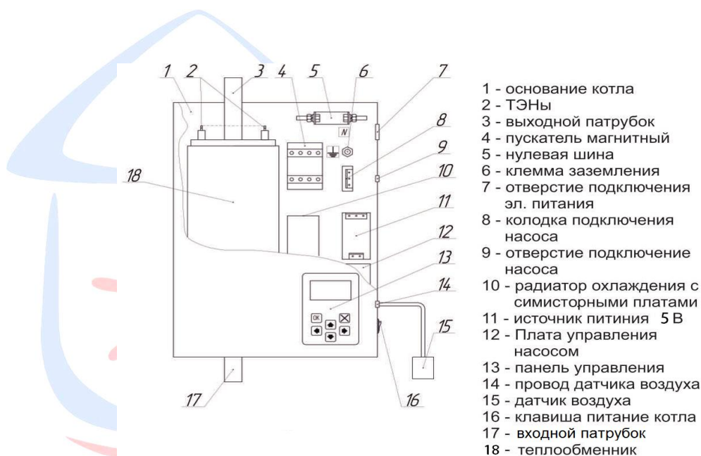
Рисунок 1. Устройство отопителя РЭКО серии П
