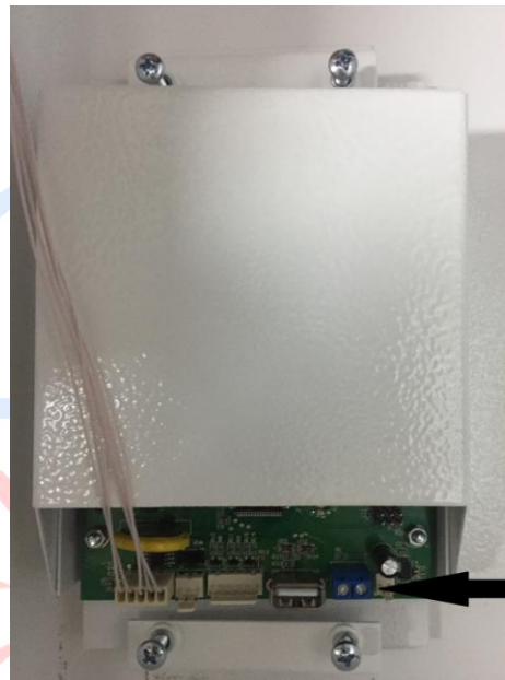
Рисунок 7. Подключение GSM модуля к электродотлу РЭКО серии ПМ
