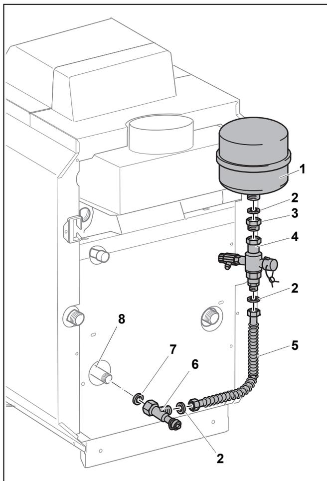
Рис.1 Монтаж комплекта расширительного бака и сливной линии
