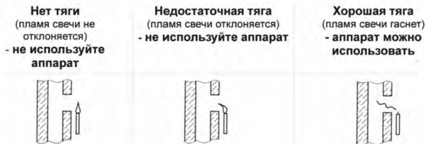
Рисунок 2. Способ проверки тяги в дымоходе
